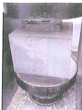
Metodo di prova : compressione sul cubetto cls con cornice metallica inferiore a supporto della camicia REFOR-tec®
