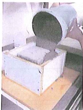
Preparazione del provino : colaggio del REFOR-tec® nell'intercapedine 30 mm tra il cubetto cls e la cassaforma
